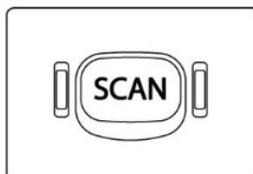
Apasati scurt acest buton pentru a incepe scanarea ascendenta a canalelor ocupate. Pentru activarea/dezactivarea scanarii canalelor, apasati scurt butonul Scan. Pictograma Scan va apare pe ecran cat timp scanarea canalelor este activa. Scanarea se va opri doar atunci cand functia este dezactivata.
