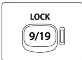
Canalul de urgenta (9/19): Apasati scurt butonul EMG pentru a trece statia pe canalul de urgenta (9 sau 19 in functie de banda de lucru). Pictograma EMG va fi afisata si vor fi active doar controlul de volum si squelch. Alte functii si taste sunt blocate. Pentru a reveni la functionarea anterioara apasati scurt din nou butonul EMG.
